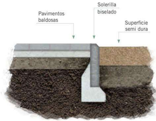
Detalle constructivo de solerilla canto biselado– MINVU (2017)
